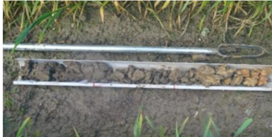
Photo 2 : Exemple de carottage sur une profondeur de 120 cm
